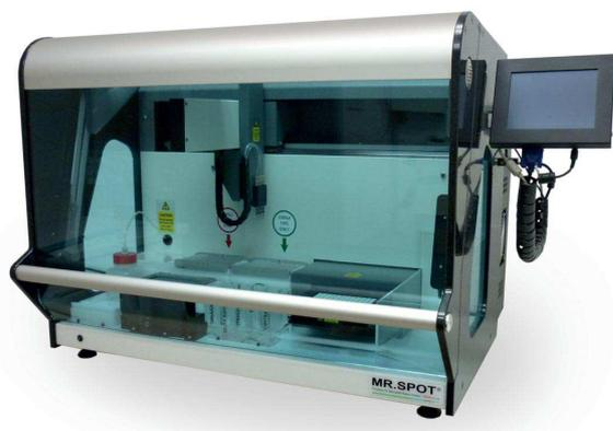
Fissare il touch screen utilizzando il braccio di supporto fornito e connetterlo a Mr. SPOT® con i relativi cavi.
