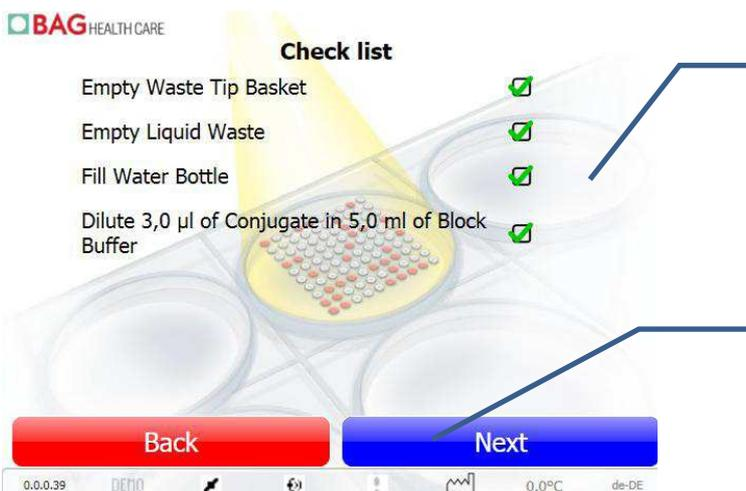
9. Dare conferma a ogni punto della check list. Utilizzare acqua distillata anzichè reagenti e i pozzetti dummy al posto dei pozzetti test
