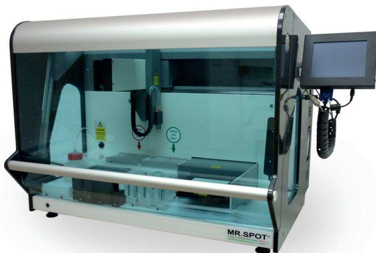
Lo strumento Mr. SPOT® è uno strumento da banco automatico per il processamento di test su micropozzetti.
